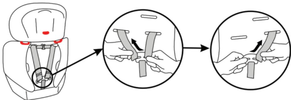
Aprire dapprima il rivestimento del sedile sul lato posteriore per accedere al sistema di cinture. Staccare entrambe le cinture dall'elemento di raccordo ed estrarre dal lato anteriore le cinture per le spalle attraverso le fessure.
