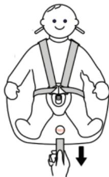
Tirare le cinture per le spalle verso l'alto per tendere le cinture per il bacino. Tirare quindi il regolatore della lunghezza delle cinture per tendere le cinture per le spalle.
