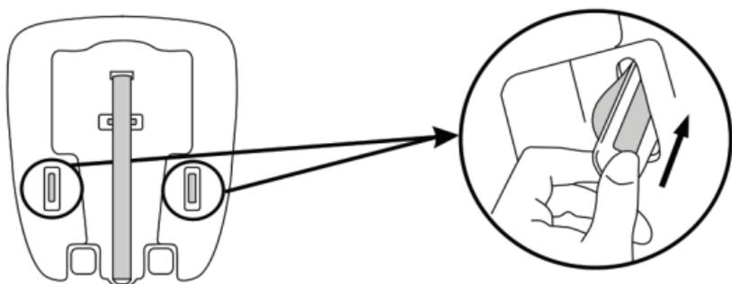
Tournez le support de sangle sur le petit côté et enfoncez-le dans le siège et la housse de siège.
