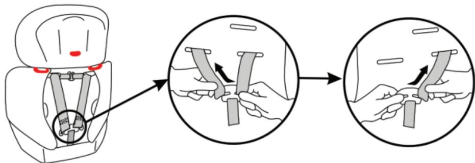
Ouvrez d'abord la housse de siège au dos du siège pour accéder au harnais. Détachez les deux sangles du passant simple et sortez les sangles d'épaule de la partie avant du siège par les fentes de la sangle.
