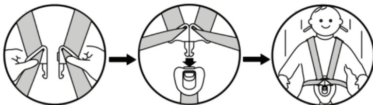
1. Schieben Sie die beiden Metallteile des Gurtes zusammen.
