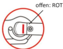
Ziehen Sie das schwarze Gehäuse der Isofix-Halterung nach hinten, um die Haken zu öffnen.
