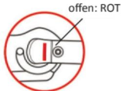
Ziehen Sie das schwarze Gehäuse der Isofix-Halterung nach hinten, um die Haken zu öffnen.
