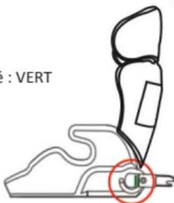
Lâchez le logement pour que les crochets s'encliquettent. La fenêtre de contrôle devient verte.
