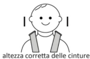
Verificare regolarmente la posizione delle cinture delle spalle – il vostro bambino cresce.
