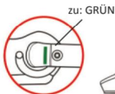
Lassen Sie das Gehäuse los, sodass die Haken einrasten. Das Kontrollfenster wird grün.
