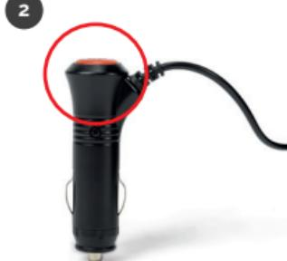
Schalten Sie die Stromversorgung bei Nichtbenutzung des Kinderautositzes bzw. der Klimax Technologie manuell ab, um ein Dauerleuchten des Displays zu vermeiden. Die Stromversorgung der Klimax Technologie schaltet sich automatisch nach 30 Minuten ab, sofern kein Kind im Kinderautositz sitzt bzw. kein Druck auf den Drucksensor ausgelöst wird.
