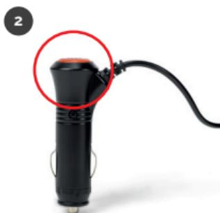
Coupez l'alimentation électrique lorsque le siège auto pour enfant ou la technologie Klimax ne sont pas utilisés, afin d'éviter que l'écran ne s'allume en permanence. L'alimentation électrique de la technologie Klimax s'arrête automatiquement au bout de 30 minutes si aucun enfant n'est assis dans le siège (aucune pression n'est alors exercée sur le capteur de pression).
